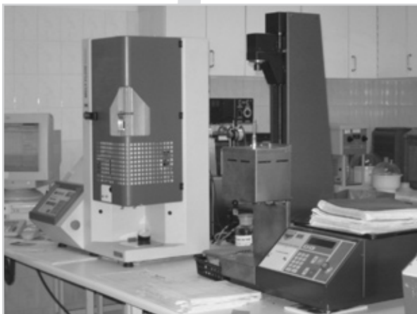
8. ábra: Folyási – MFR – szám vizsgáló készülékek
