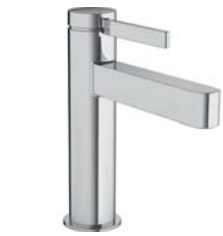
EGYKAROS MOSDÓCSAPTELEP 110 COOLSTART · A fogantyú középső pozícióban hideg vizet nyit · Fém Push-Open lefolyógarnitúrával #76024 -000 #76024, -670, -700 Normál változatban #76020, -000 #76020, -670, -700
