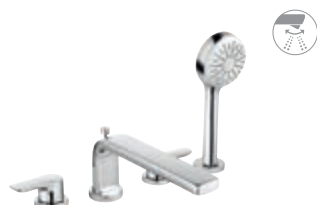
384230575 kádöntő- és zuhanycsaptelep négylyukas szerelésű, alsóhidas kivitel kifolyó benyúlása 220 mm
